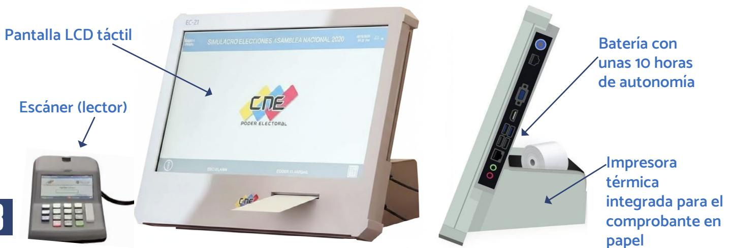
No obstante, del informe de las auditorías realizadas por técnicos independientes se puede concluir que los equipos estarían conformados por una pantalla táctil de 15-17 pulgadas en formato apaisado. Cuerpo plástico inclinado con ranura frontal de impresora (térmica de 58-80 mm), algunos botones físicos/LED y puertos laterales (USB, etc.).
