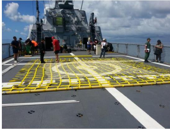
TUBO DE PBC COLOCADO AL BORDE DE LA MALLA PARA PODER ENROLLAR Y DESENROLLAR CON RAPIDES.
