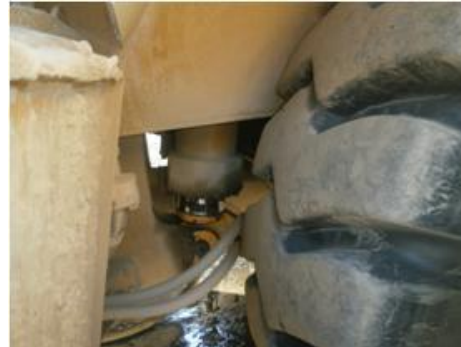
Ilustración 119. Mecanismo de elevación de la tolva para el camión dúmper Caterpillar.
